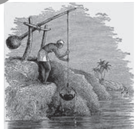
Mit einem solchen Bewässerungsgerät wurde das Wasser aus dem Nil geschöpft, um es dann in Wasserbecken oder Kanäle zu gießen.
